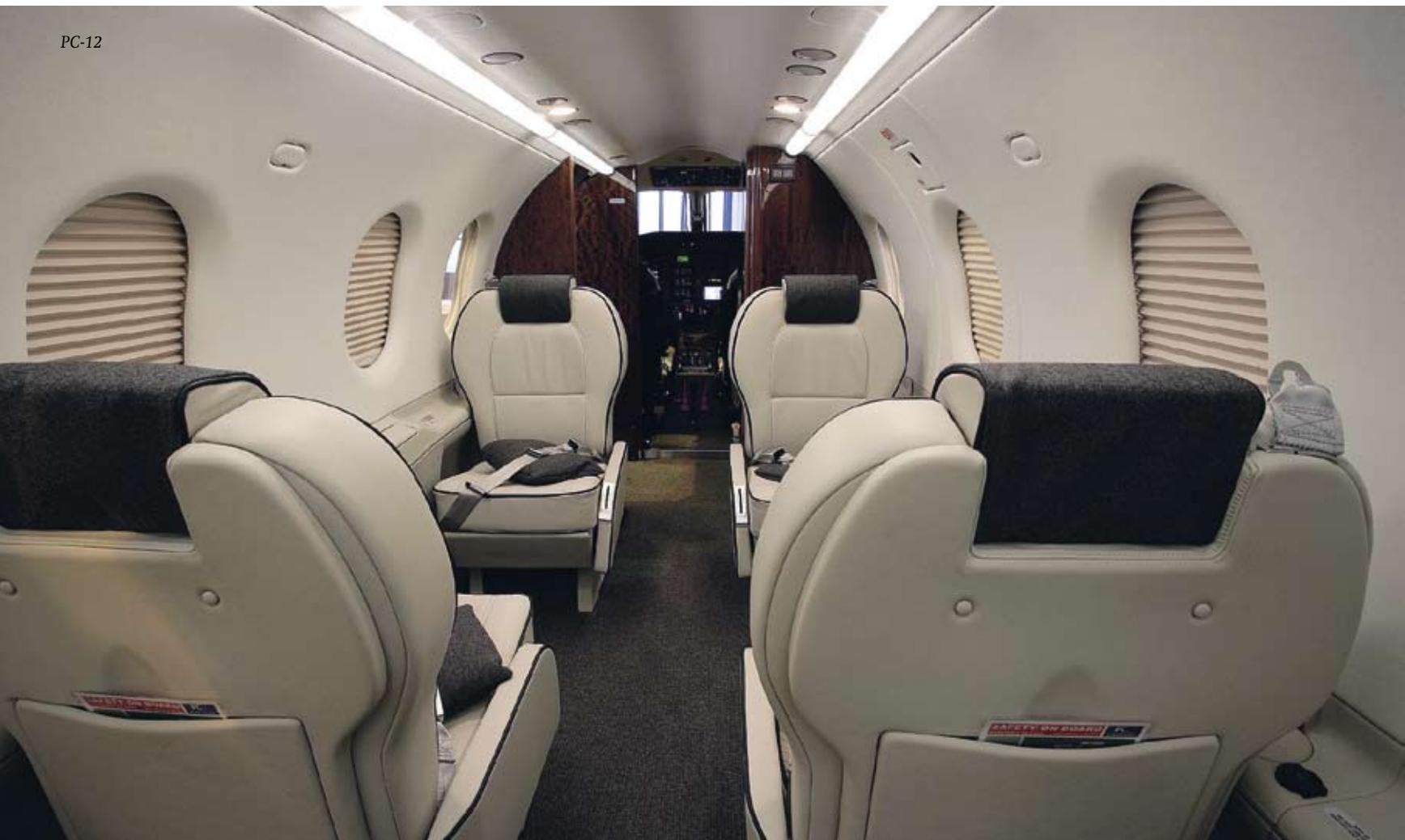
фюзеляж с очень удачным использованием внутренних объемов. Самолет проектировали «вокруг гермокабины».
